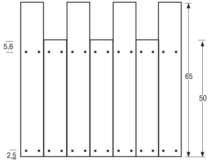
Puntos de perforación para atornillar con tornillos de 3x30 mm
